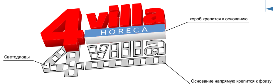
Схема конструкции светового короба
